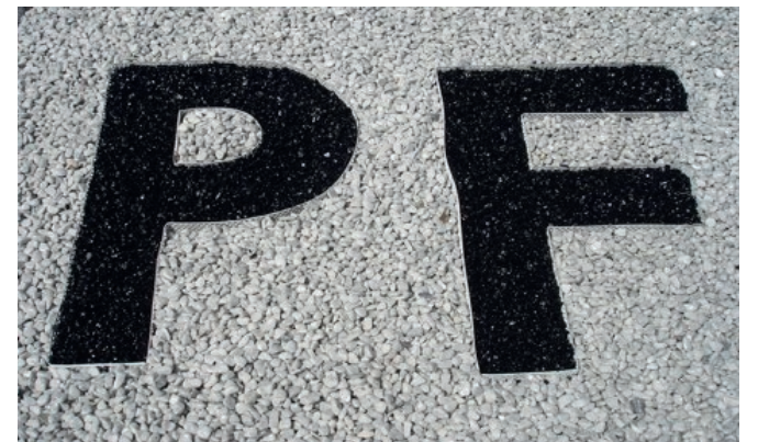
Heller und dunkler Zierkies, gebunden mit UV-beständigem PCI Pavifix PU Bindemittel.
