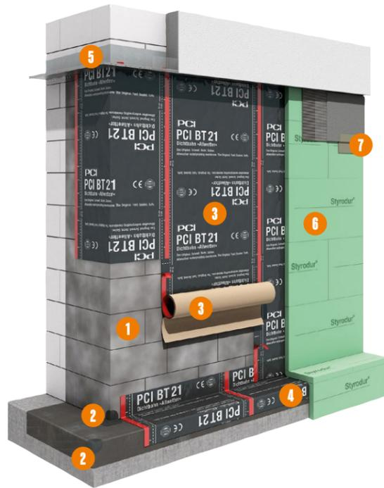
\* kaltselbstklebende Bitumen-Dichtbahn
