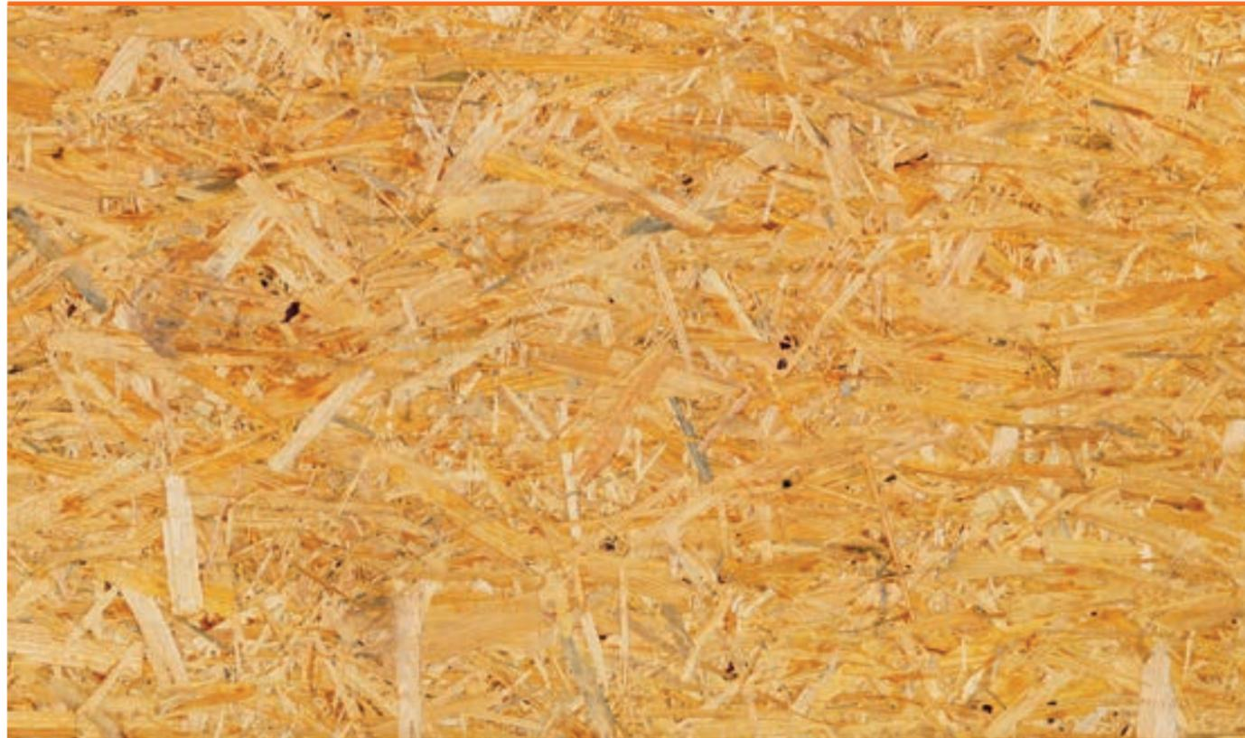
Holz ist ein „lebender“ Baustoff und verformt sich – im Gegensatz zum keramischen Fliesenbelag – bei Feuchtigkeitsbelastung und unter Einfluss von Wasserdampf (Quellen und Schwinden). Bei geeigneter Vorbereitung (Dampfsperren und Abdichtungen) können aber auch Untergründe aus Holz- und Spanplatten an Wänden im Innenbereich sicher mit Fliesen und Platten belegt werden. Am Boden ist jedoch häufig zuvor eine Stabilisierung mit der nachfolgend beschriebenen Methode erforderlich.
