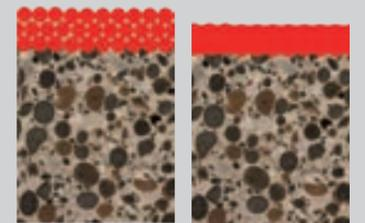
Das Wasser wird der Grundierung durch Verdunstung und Einziehen in den Untergrund entzogen, die Kunststoffpartikel beginnen zu verfilmen.
